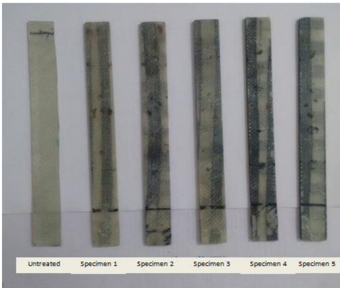
Fig.3: VEM embedded composite plates
