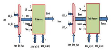
Fig. 3e IL Processor Data Memory Entity
